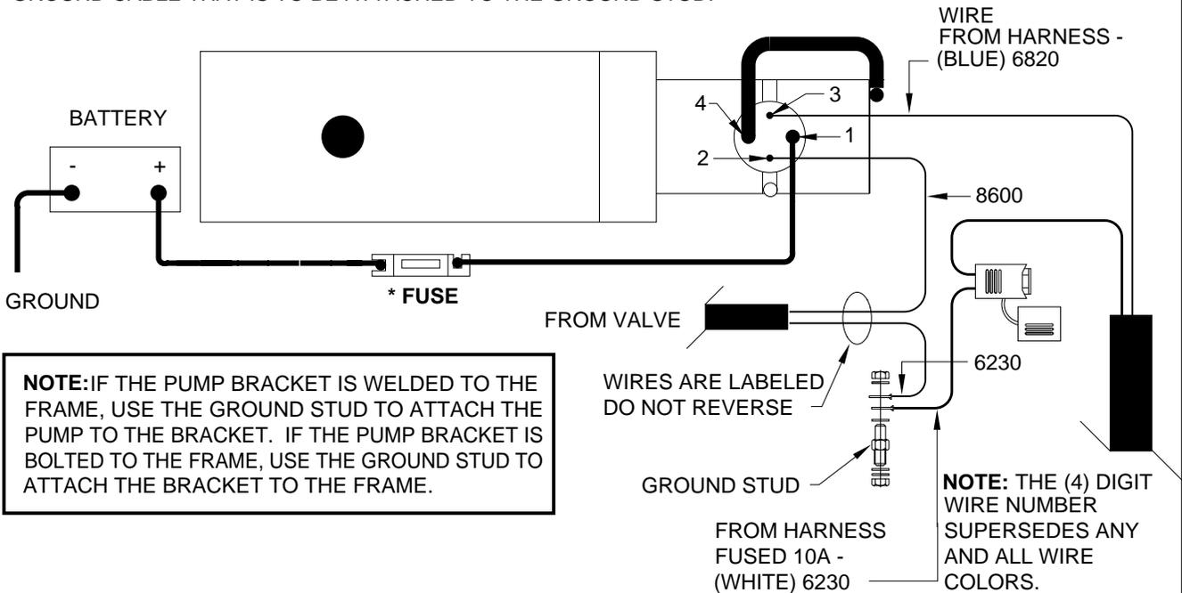
**NOTE:** IF THE PUMP BRACKET IS WELDED TO THE FRAME, USE THE GROUND STUD TO ATTACH THE PUMP TO THE BRACKET. IF THE PUMP BRACKET IS BOLTED TO THE FRAME, USE THE GROUND STUD TO ATTACH THE BRACKET TO THE FRAME.
