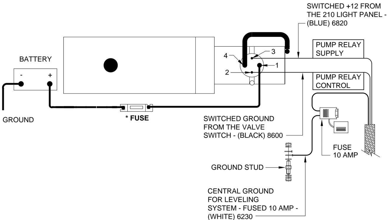
**NOTE: IF THE PUMP BRACKET IS WELDED TO THE FRAME, USE THE GROUND STUD TO ATTACH THE PUMP TO THE BRACKET. IF THE PUMP BRACKET IS BOLTED TO THE FRAME, USE THE GROUND STUD TO ATTACH THE BRACKET TO THE FRAME.**
